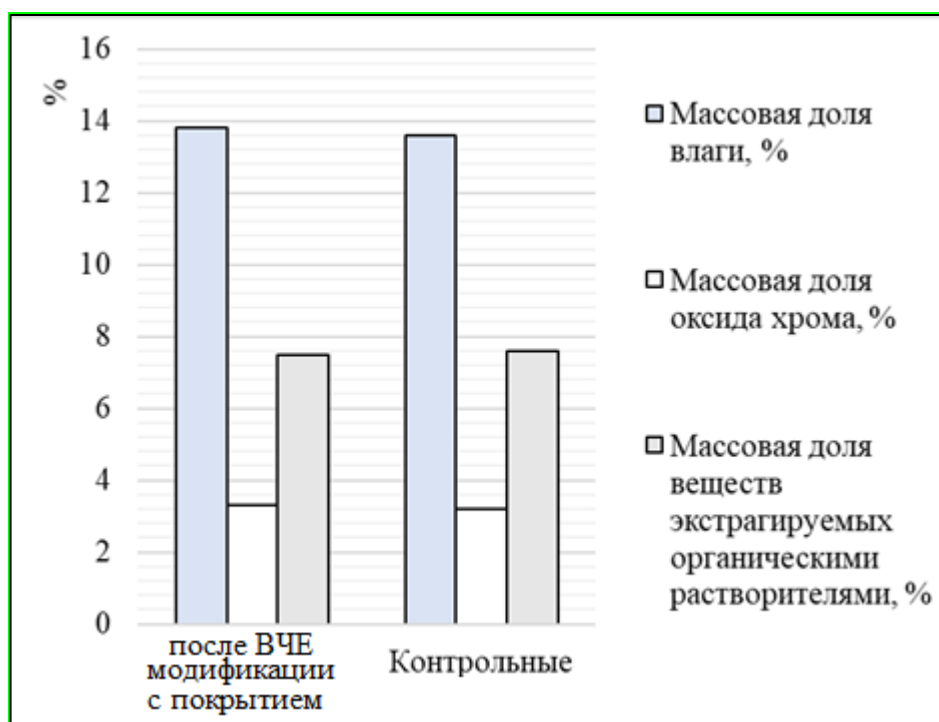
Рисунок 3.11 – Состав летучих компонентов и окиси хрома в кожаных образцах после ВЧ плазменной обработки
