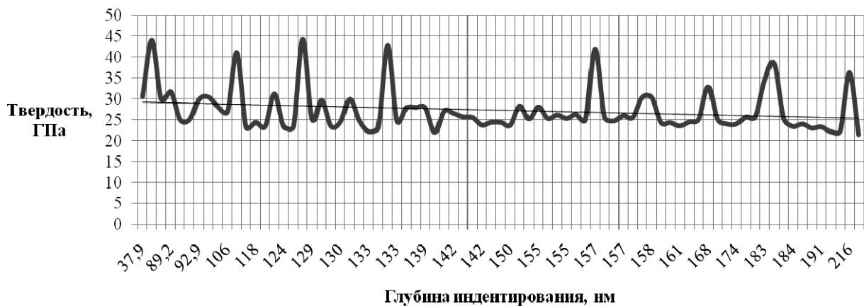
Рисунок 3.36 – Результаты определения микротвердости многослойного покрытия из нитридов титана и гафния и динамика этого показателя в зависимости от глубины индентирования
