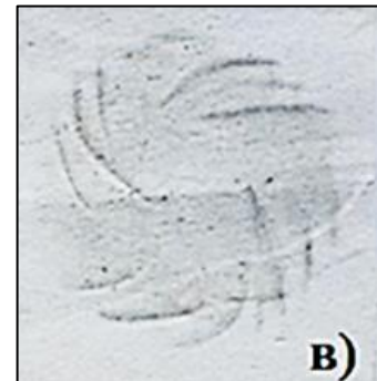
натуральная кожа, обработанная в ВЧЕ - разряде и с покрытием (Ti+Hf)N после хранения 6 месяцев
