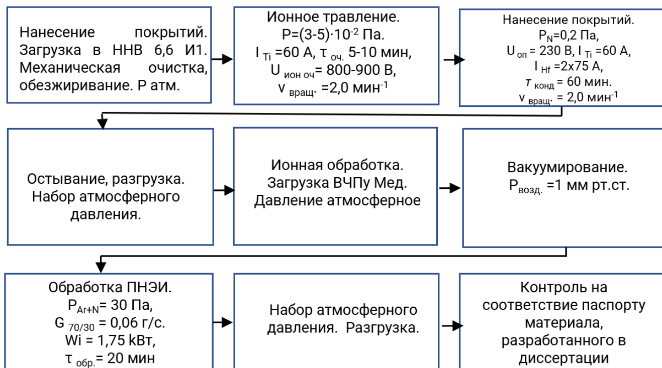
Рисунок 6.2 – Схема получения металлического биомедицинского материала с многослойными наноструктурированными нитридными гафниево-титановыми покрытиями, обработанными потоком низкоэнергетических ионов, генерируемых из высокочастотной плазмы пониженного давления
