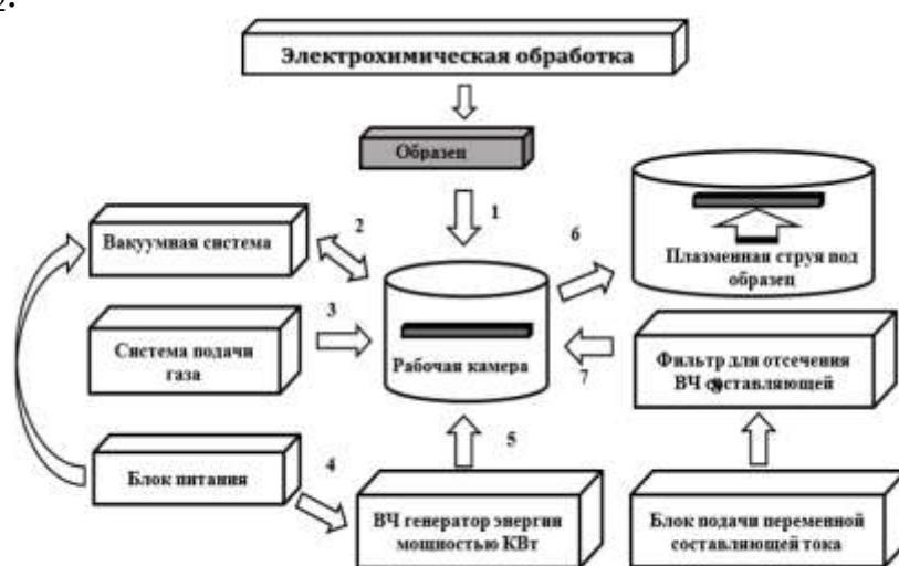
Рисунок 10 – Общая схема комбинированного метода электрохимической модификации и низкотемпературной плазменной обработки
