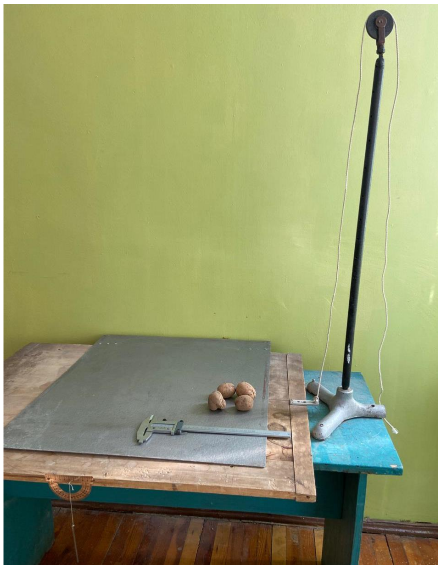
Рисунок 3.4 – Прибор для определения углов трения клубней картофеля
