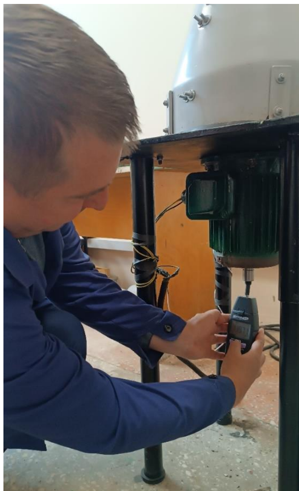
Рисунок 3.12 – Определение частоты вращения ротора
