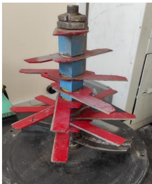
Рисунок 3.8 – Ротор в сборе и измельчающие ножи
