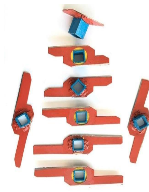
Рисунок 3.8 – Ротор в сборе и измельчающие ножи
