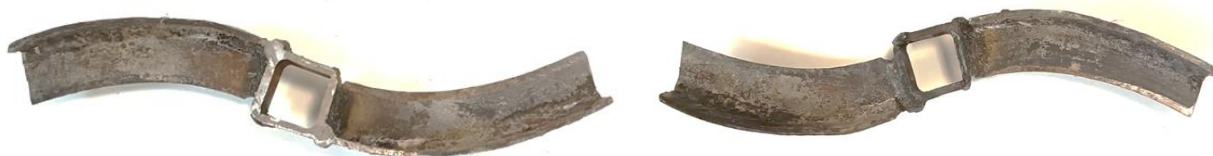
Рисунок 3.11 – Швырялки выгрузной камеры
