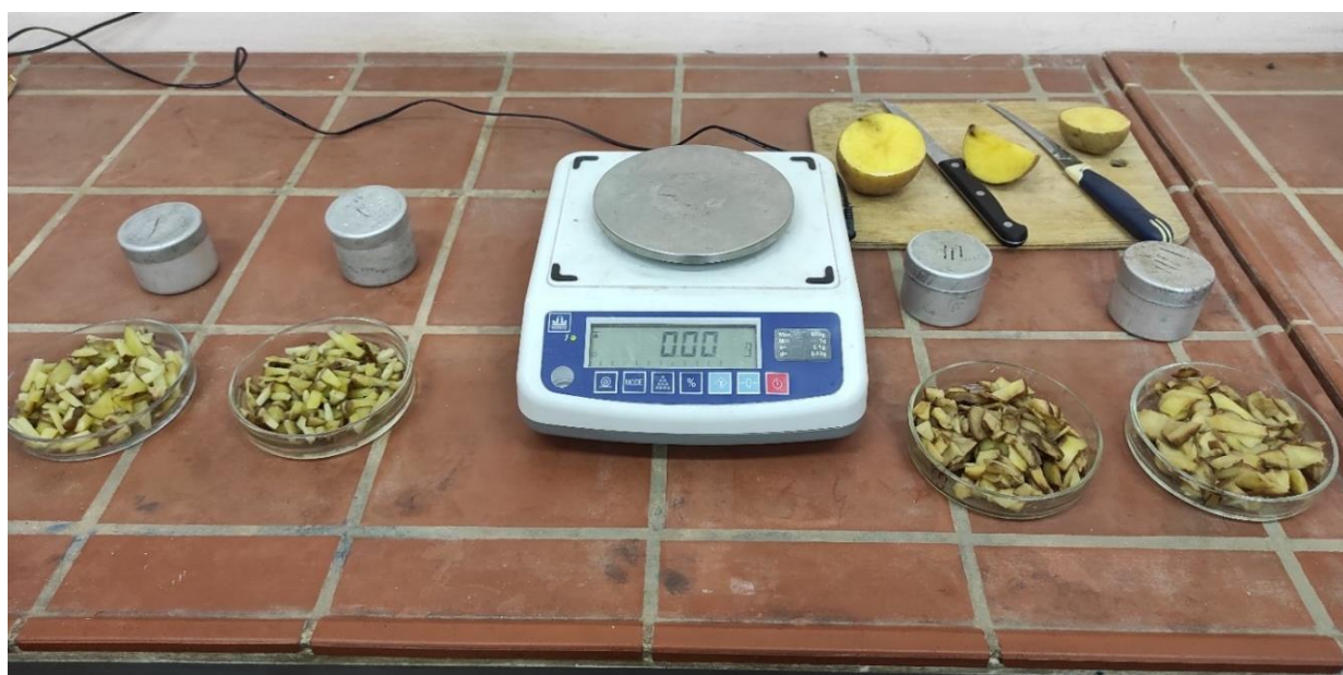
Рисунок 3.2 – Приборы и материал для определения влажности
