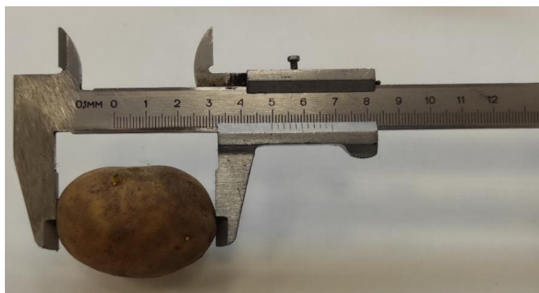
Рисунок 3.14 – Определение геометрических параметров клубней
