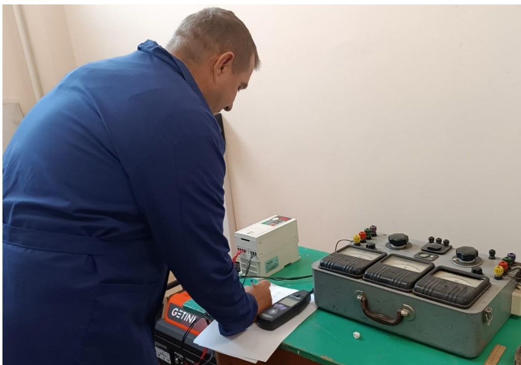
Рисунок 3.13 – Определение электрических и энергетических показателей экспериментальной установки с помощью переносного измерительного комплекта типа К-50
