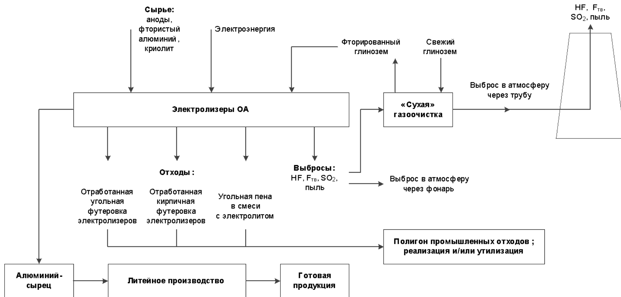
Рисунок 2.2.3 – Блок-схема производства первичного алюминия в электролизерах с обожжёнными анодами [55]
