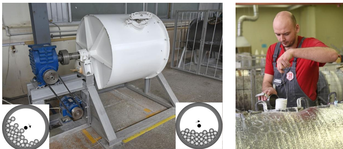
Рисунок 1.2 – Шаровая мельница и операция взятия промежуточного анализа подсистемы подготовки сырья [319]
