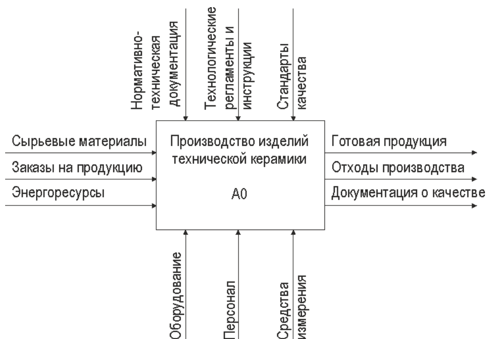
Рисунок 1.3 – Контекстная диаграмма A0 «Производство изделий технической керамики (составлено автором)
