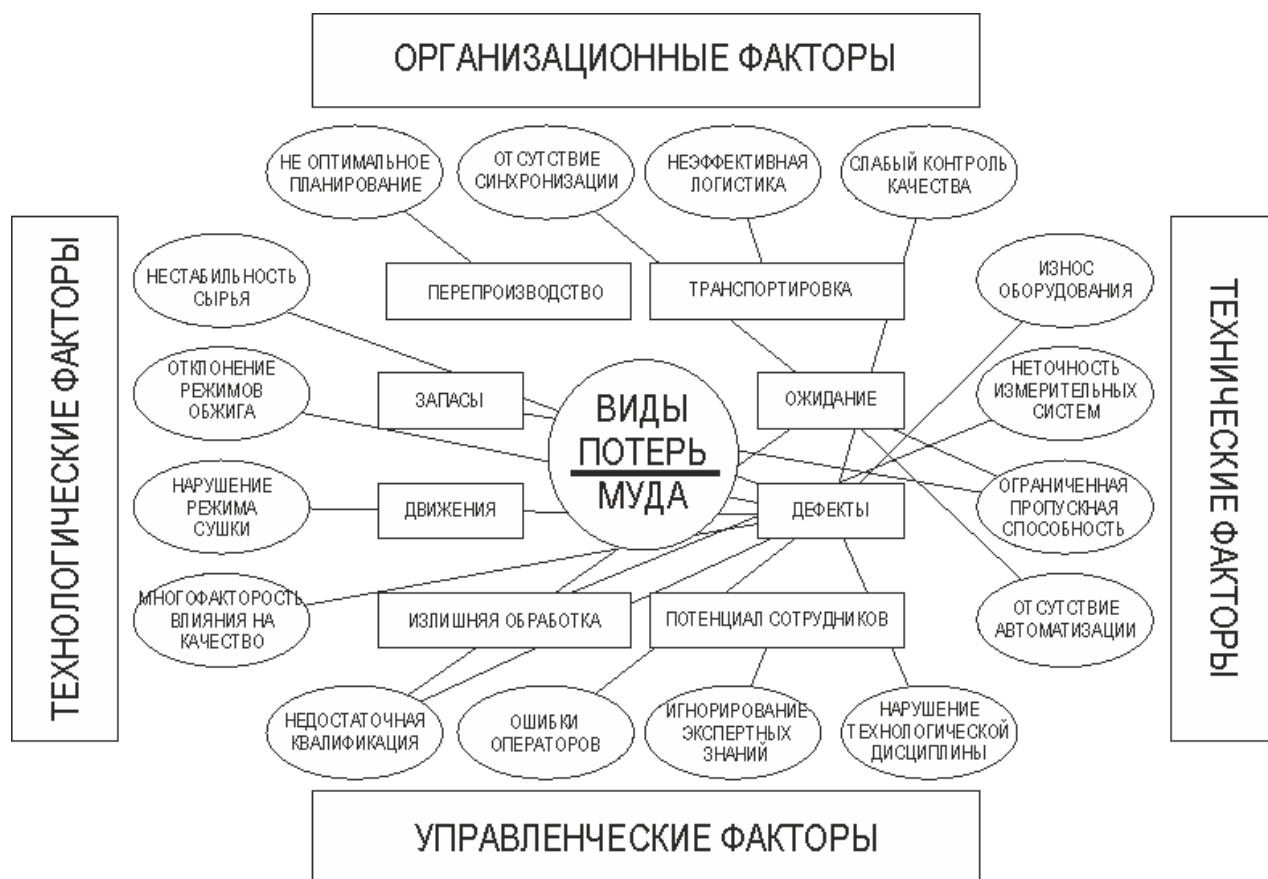
Рисунок 1.11 – Когнитивная карта взаимосвязей факторов производства и технологических потерь
