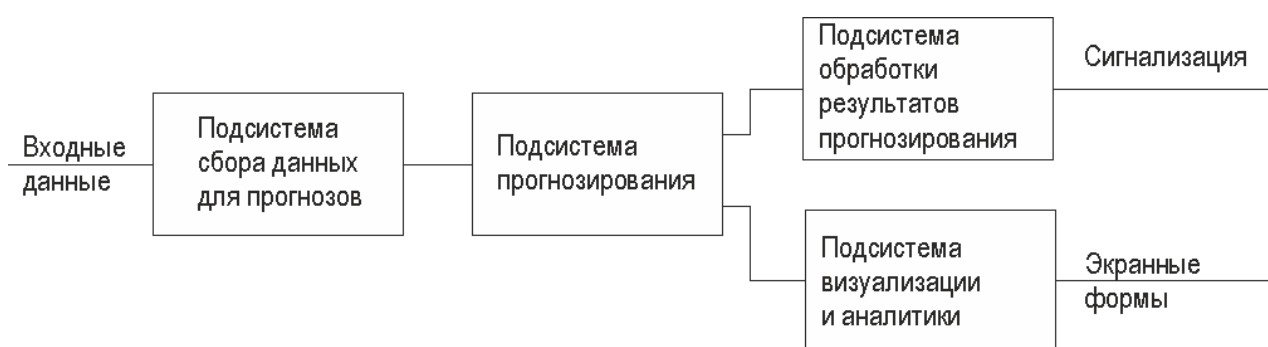
Рисунок 3.6 - Диаграмма взаимодействия компонентов модуля управления качеством (составлено автором)
