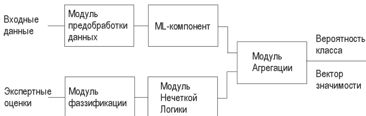
Рисунок 2.2 – Концептуальная схема гибридной модели прогнозирования качества (составлено автором).
