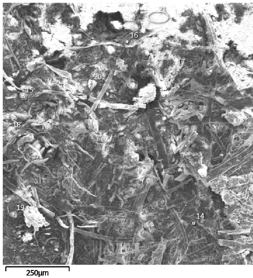
Рисунок 3.3 – ШОПГ после обжига при 250 °С при разных увеличениях
