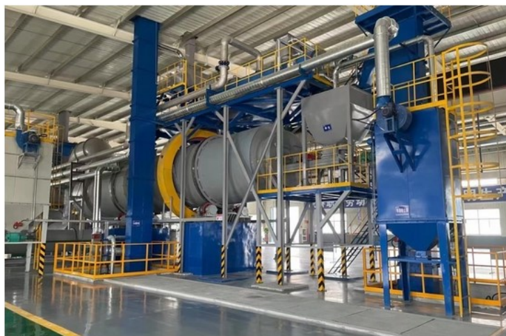
Рисунок 1.9 – Технологическая линия производства древесного активированного угля
