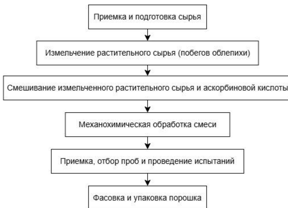
Рисунок 1.8 – Схема получения порошка с БАВ из побегов облепихи
