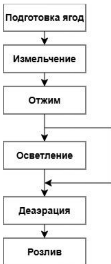
Рисунок 1.2 – Схема производства облепихового сока прямого отжима
