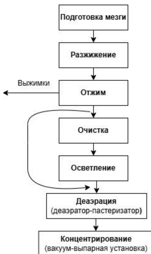
Рисунок 1.3 – Этапы производства облепихового диффузионного сока
